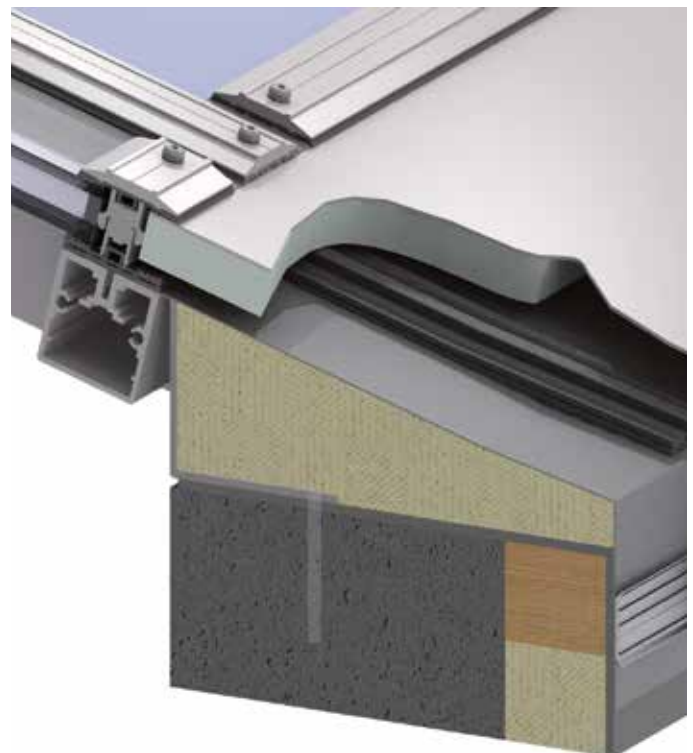
MONTAGE OP BETONWAND
